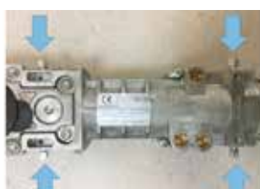
Position des vis d'azimutage en partie basse et haute du pivot.
